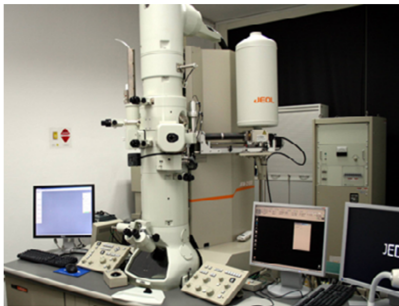
Transmisyjny mikroskop elektronowy (TEM) JEOL JEM-2100- wysoko- rozdzielczy o napięciu 200kV, z systemem EDS oraz układem cyfrowej rejestracji obrazów.
